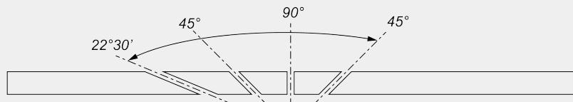
Réglage mécanique des angles intermédiaires
