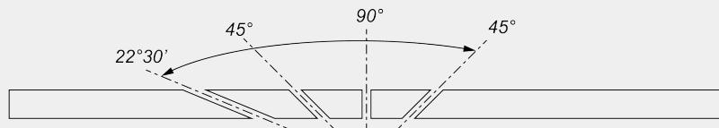
Réglage mécanique des angles intermédiaires
