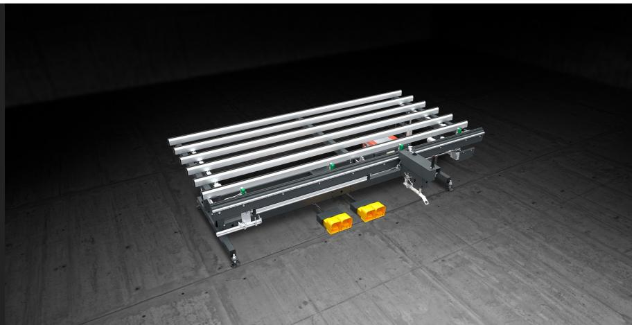
Arbeitstisch für die Montage von Bandbeschlägen an Flügeln aus Aluminium, Holz und PVC. Ein versenkbares Spannsystem sorgt für die Einspannung des Flügels. Der Arbeitstisch ist mit einem Anschraubsystem mit Selbstspeisung sowie, als Optional, mit einem System für die Messung und den Schnitt der Beschläge mit einer hydropneumatischen Schere ausgestattet.
