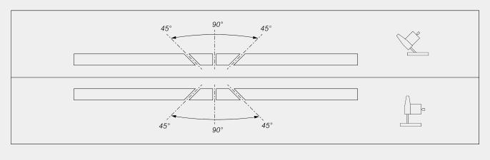
Mechanische Einstellung der Zwischenwinkel
