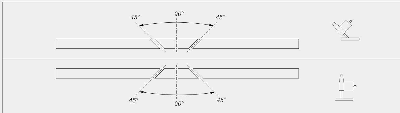
Mechanische Einstellung der Zwischenwinkel
