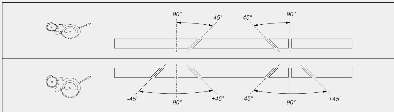
Mechanische Einstellung der Zwischenwinkel
