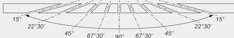
Mechanische Einstellung der Zwischenwinkel
