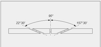
Elektronische Einstellung der Zwischenwinkel
