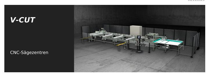
Sägezentrum mit 3 CNC-gesteuerten Achsen, vollautomatisch, zum Schneiden von Profilen aus Aluminium, PVC und allgemeinen Leichtmetalllegierungen. Ausgehend vom fließgepressten Profilstab führt das V-CUT im Automatikbetrieb das Laden, Schneiden und Entladen von vorgegebenen und optimierten Schnittlisten aus. Vorgesehen ist die Maschine für Schnitte mit Winkeln von 45° bis 135° oder von 22°30′ bis 157°30′.
