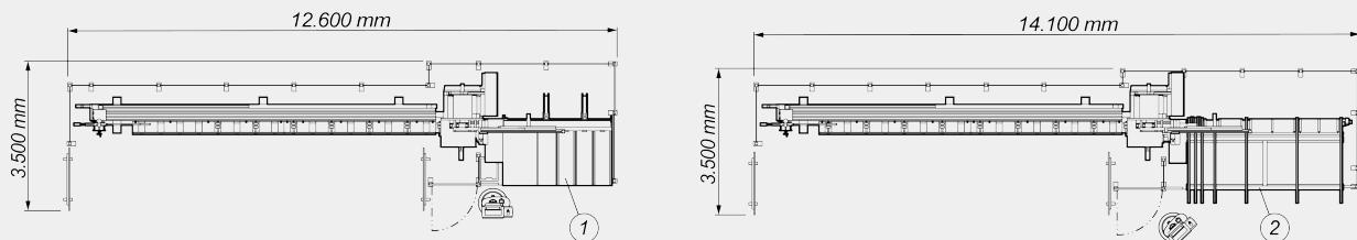
1. Entlademagazin mit automatischer Entnahmeeinrichtung (Standard)
