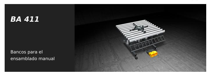
Banco para el ensamblaje de hojas acristaladas con plano de apoyo inclinable desde 0° (horizontal) a 85°. La base de rodillos retráctil puede regularse en altura (desde 170 a 460 mm) independientemente del plano apoyo. El plano de apoyo puede regularse desde 895 a 965 mm y las patas poseen agujeros para su fi jación al suelo. Se suministra con una cruceta central para la elevación y el posicionamiento del cristal.
