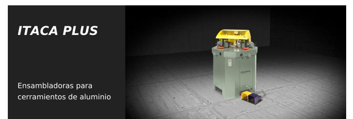
Ensambladora para cerrar ángulos de perfiles de aluminio para puertas, ventanas y fachadas. Se regula fácilmente gracias a la traslación de las unidades de punzonado. Los bloqueos de los cuchillos están dotados de desenganche rápido e imanes para evitar que caigan. Dotada de lectura digital del movimiento de los cabezales de ensamblaje y de la hoqruilla de referencia de los perfiles. Las regulaciones son más fáciles gracias a la facilidad de lectura de la pantalla.
