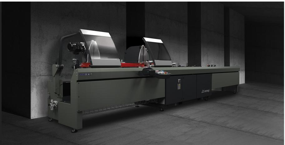
Tronzadora de doble cabezal electrónica con movimiento automático del cabezal móvil mediante motor brushless accionado por un control numérico. Inclinación neumática de las unidades de corte de 90o hasta 22o 30' (externa) con sistema mecánico de regulación de los ángulos intermedios. Avance disco aceite-neumático.
