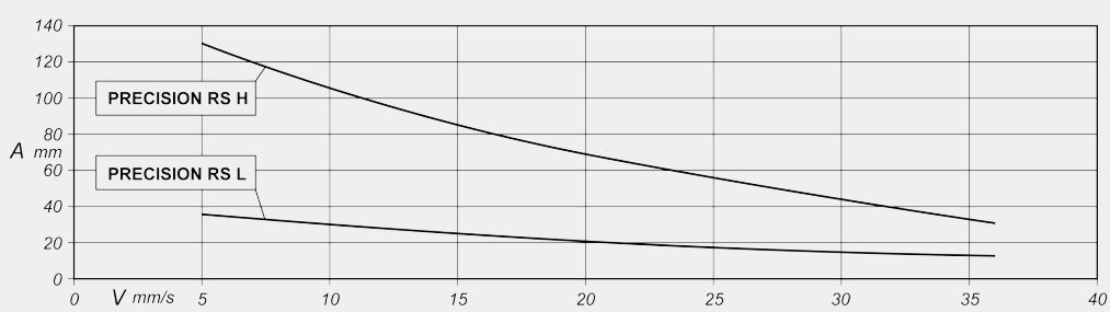
A = arco de contacto (mm) V = velocidad de avance del disco (mm/s)
