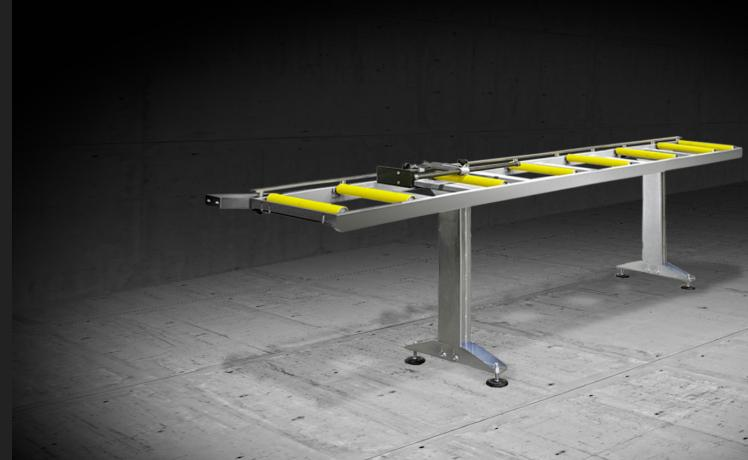
Construcción de acero tubular con patas de montaje ajustables y rollos de acero cubiertos de PVC. En la versión con rollo de 240 mm, la longitud del transportador de rodillos es de 3.500 mm; con rollos de 440 mm, la longitud del transportador de rodillos es de 4.000 mm.
