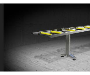
Structure en éléments tubulaires d'acier avec pieds réglables et rouleaux en acier revêtus en PVC. Rouleaux de 240 mm, la longueur du chemin atteint 3.500 mm ou avec des rouleaux de 440 mm, la longueur du chemin est de 4.000 mm.
