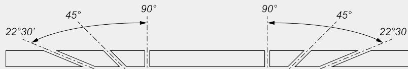
Réglage mécanique des angles intermédiaires
