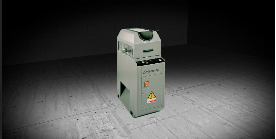
Grueuse en bout horizontale à avance manuelle. Fraisage en biais à +45° / 90° / -45°. Changement rapide du groupe de fraisage assuré par commande pneumatique. Table de travail anti-rayures. Protection intégrale de la zone d'usinage.
