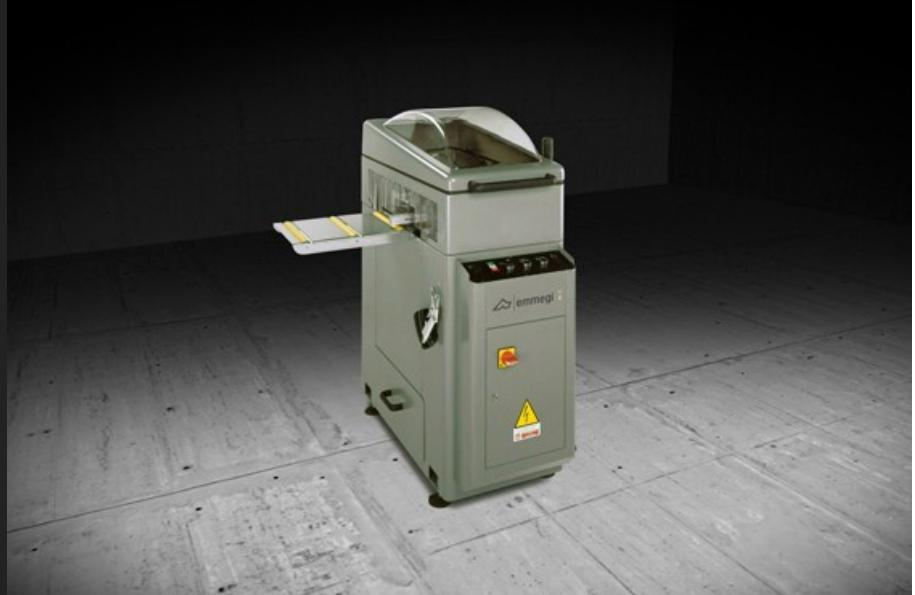
Grugeuse en bout horizontale à avance électropneumatique. Fraisage en biais à +45° / 90° / -45°. Vitesse élevée de rotation de l'outil, 6000 tours/ min., afin d'améliorer la qualité de l'usinage sur les profilés peints et en biais. Changement rapide du groupe de fraisage assuré par commande pneumatique. Table de travail anti-rayures. Zone d'usinage intégralement protégée par un carter et dotée d'une large visibilité intérieure.
