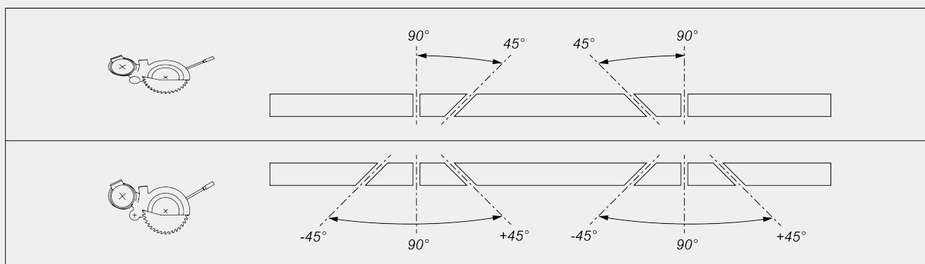
Réglage mécanique des angles intermédiaires
