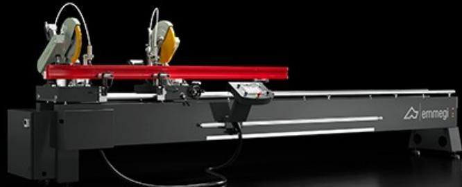
Tronçonneuse double tête avec mouvement manuel de la tête mobile et détection de la position au moyen d'une bande magnétique absolue. La rotation des unités de coupe sur l'axe vertical (45° vers la gauche et vers la droite) et l'inclinaison sur l'axe horizontal (45° internes), avec réglage manuel, permettent de réaliser des coupes débillardées même à des angles intermédiaires.
