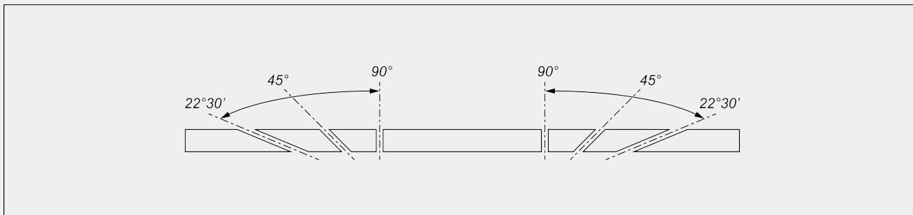
Réglage mécanique des angles intermédiaires
