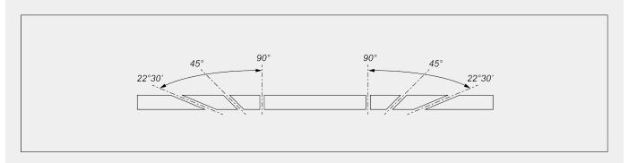
Réglage mécanique des angles intermédiaires
