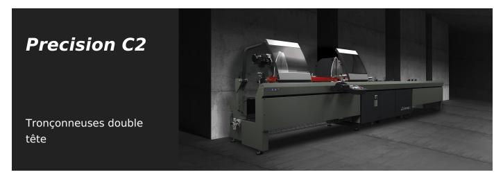
Tronçonneuse à double tête électronique, mouvement automatique de la tête mobile grâce à un moteur brushless à commande numérique par calculateur. Inclinaison pneumatique des unités de coupe à 90° jusqu'à 22°30' (externe) avec un système mécanique de réglage des angles intermédiaires. Avancement oléopneumatique de la lame.
