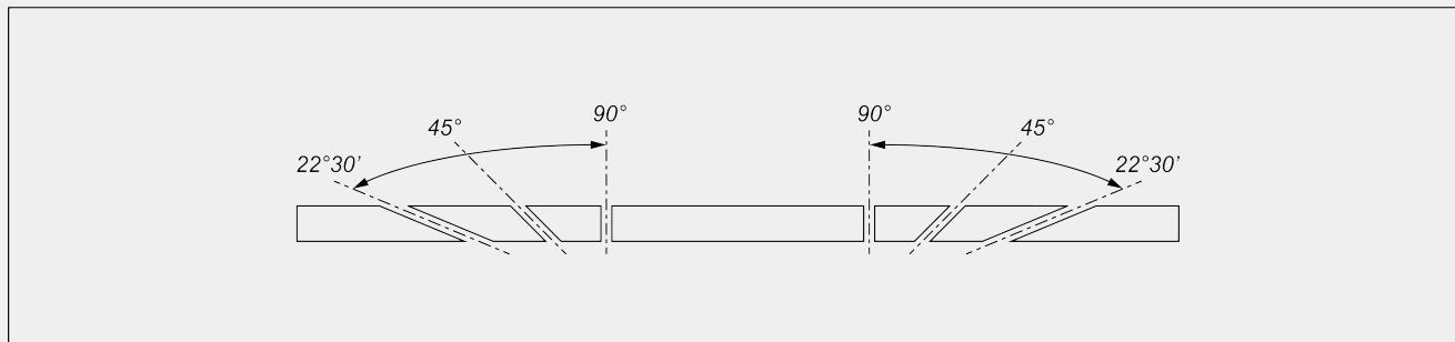
Réglage mécanique des angles intermédiaires
