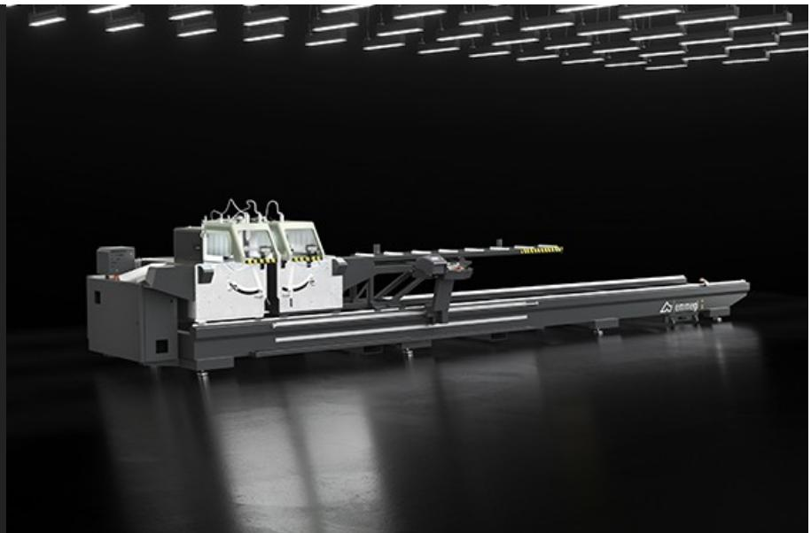
Tronçonneuse double tête électronique avec mouvement radial des lames, déplacement automatique de la tête mobile sur patins à recirculation de billes au moyen d'un système à pignon et crémaillère ; pivotement intérieur jusqu'à 30°, conçue pour la coupe de profils de grandes dimensions. L'avance de la lame est actionnée par deux cylindres oléopneumatiques.
