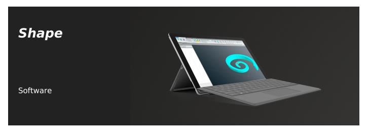
Shape est un logiciel permettant de créer librement des figures de toutes formes: lignes, arcs, orifices. Possibilité d'importer des figures au format DXF. L'affichage en 3D permet de mieux suivre les figures lorsque la profondeur n'est pas constante. Shape permet d'obtenir plus rapidement des usinages qui auraient dû passer par la composition de figures «standard».
