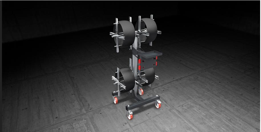
Dévidoir à joint. Un dévidoir avec frein et un guide-fil assurent le débobinage sans encombre du joint. Equipé d'un système de changement rapide des bobines.
