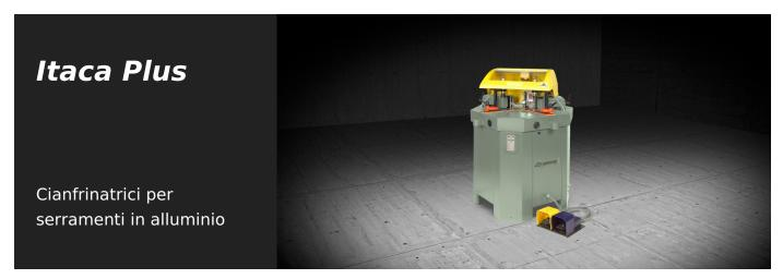
Cianfrinatrice per chiudere angoli di profilati in alluminio per porte, finestre, e facciate. Facile da regolare grazie alla traslazione delle unità di punzonatura. I blocchi coltelli sono dotati di sgancio rapido e calamite per evitare la caduta degli stessi. Dotata di lettura digitale dello spostamento delle teste di cianfrinatura e della forcella di riferimento dei profilati. Le regolazioni sono semplificate dalla facilità di lettura del display.
