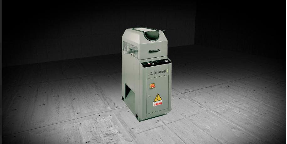
Intestatrice orizzontale ad avanzamento manuale. Fresatura fuori quadro +45° / 90° / -45°. Cambio rapido del gruppo frese con comando pneumatico. Piano di lavoro antigraffio. Protezione integrale zona lavoro.
