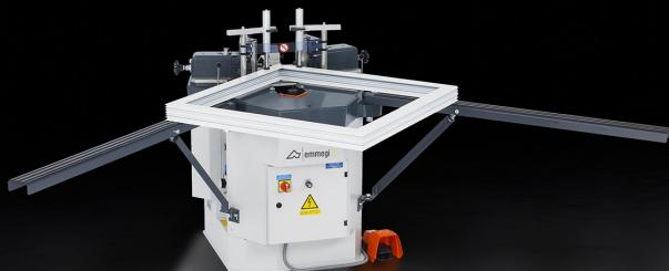
Cianfrinatrice pneumatica per la pressatura di profili di grandi dimensioni e facciate strutturate, con elevati requisiti di qualità. I suoi maggiori punti di forza sono: la facilità di configurazione e uso, con tempi di attrezzaggio e regolazione ridotti al minimo; l'estrema robustezza della struttura che conferisce alta precisione alla lavorazione; la grande forza di pressatura è fornita da un cilindro a soffietto di grande volume che non richiede manutenzione.
