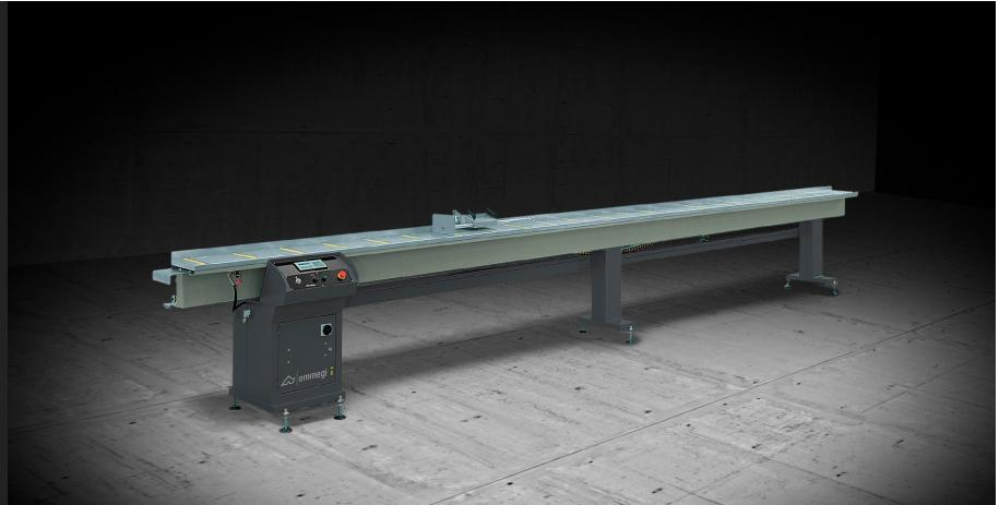
Sistema di riscontro della misura e supporto profilo con movimento del fermo mediante motore C.C. e lettura elettronica tramite encoder.
