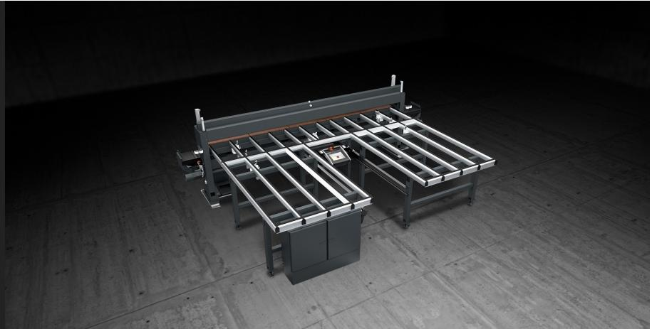
MOD-END RIFILA è una rifilatrice per cornici in PVC a due assi controllati a ciclo semiautomatico. È dotata di un'unità di taglio CN regolabile in velocità di avanzamento.
