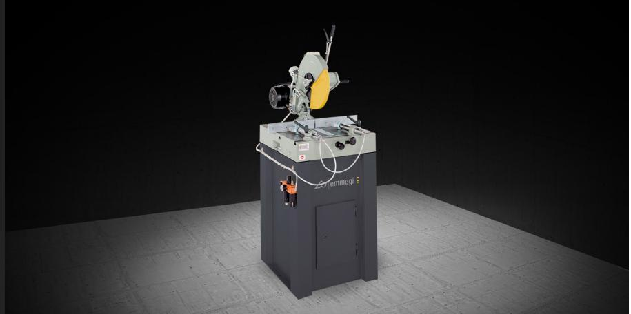
Troncatrice monotesta con lama discendente con lato di carico a sinistra, rotazione dell'unità di taglio a 45° (sinistra e destra) e ribaltamento manuale a 45° in rapporto all'asse orizzontale.
