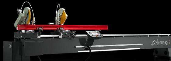
Troncatrice doppiatesta con movimento manuale della testa mobile e rilevamento della posizione mediante banda magnetica assoluta. La rotazione delle unità di taglio su asse verticale (45° verso sinistra e destra) e l'inclinazione su asse orizzontale (45° interni), con regolazione manuale, consentono tagli combinati anche ad angolazioni intermedie.
