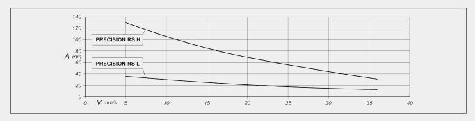
A = arco di contatto (mm) V = velocità avanzamento lama (mm/s)
