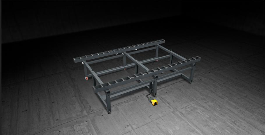
Banco modulare di grandi dimensioni dedicato all'assemblaggio ed alla movimentazione in linea di celle di facciata. È corredata di due piste di rulli ricoperti con guaina di PVC morbido; la distanza tra le due piste è regolabile manualmente in base all'ampiezza del serramento che si deve lavorare. Un sistema azionabile pneumaticamente consente di bloccare i rulli durante le fasi di lavoro.
