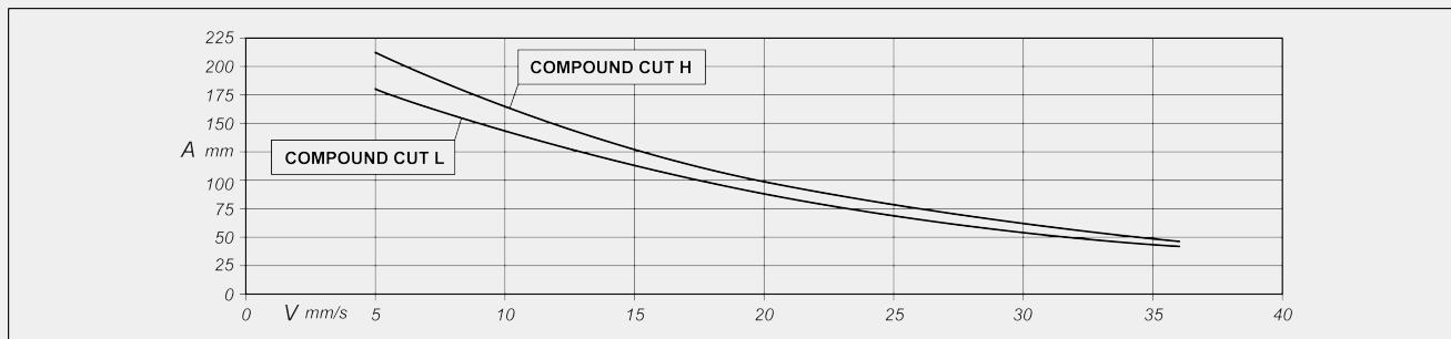
A = arco de contacto (mm)      V = velocidade de avanço da lâmina (mm/s)
