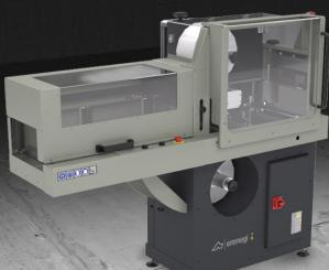
Máquina para a aplicação de uma película protetora sobre perfis de alumínio. O avançamento do perfil é feito automaticamente mediante roletes motorizados e a perfeita adesão da película ao perfil é garantida por intermédio de roletes prensadores. Um kit adicional, opcional, permite aplicar a película, simultaneamente, também sobre uma terceira face.
