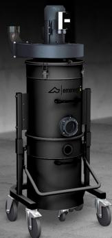
Sistema de aspiração de aparas das unidades de trabalho com alimentação autónoma e ativação automática na máquina. Ideal para o alumínio, aço e PVC. A utilização de uma ventoinha de grande capacidade torna este aparelho idóneo para as diversas exigências de aspiração. Sistema automático vibratório de limpeza do filtro e tanque de recolha com desengate rápido montado em rodas para a eliminação simples e rápida do material aspirado.
