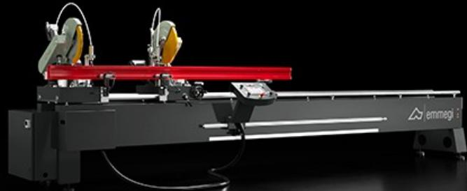
Máquina de corte de cabeça dupla com movimento manual da cabeça móvel e deteção da posição através de barra magnética absoluta. A rotação das unidades de corte no eixo vertical ( $45^\circ$  para a esquerda e para a direita) e a inclinação no eixo horizontal ( $45^\circ$  internos), com regulação manual, permitem cortes combinados também com ângulos intermediários.
