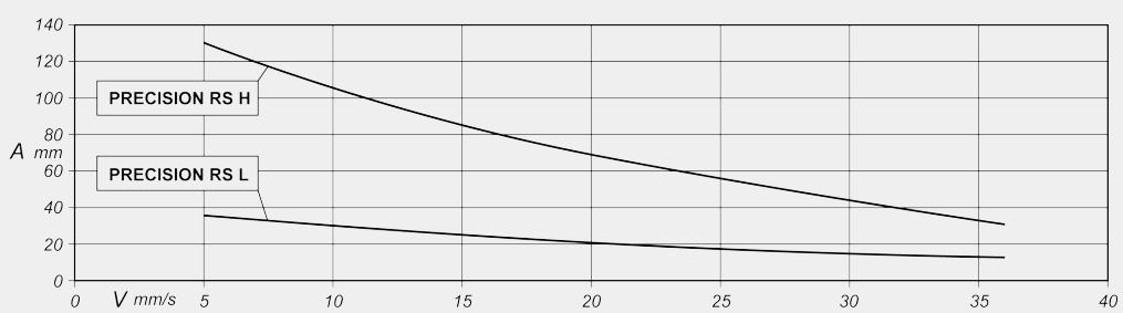
A = arco de contacto (mm)      V = velocidade de avanço da lâmina (mm/s)
