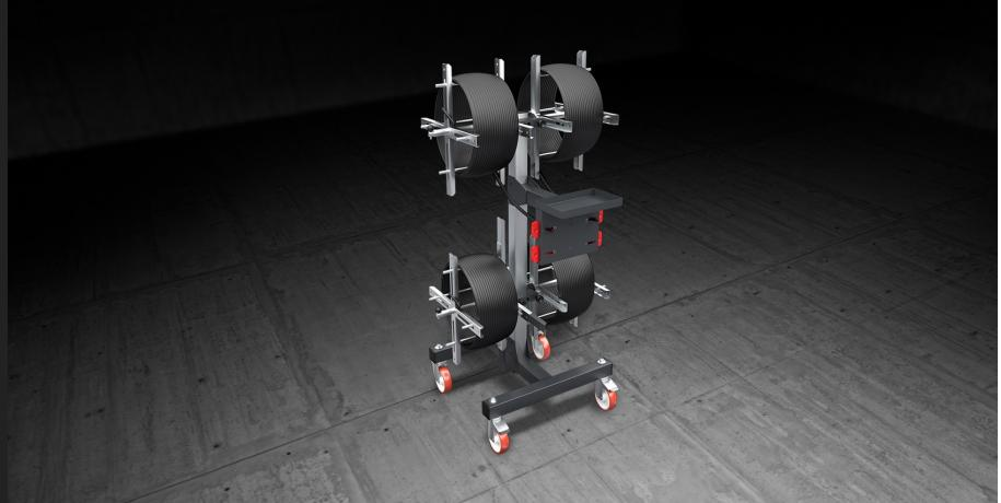
Carro porta-juntas. A dobradoura friccionada e o guia-fio garantem a desbobinagem sem inconvenientes da junta. Está equipado com sistema de troca rápida das bobinas.
