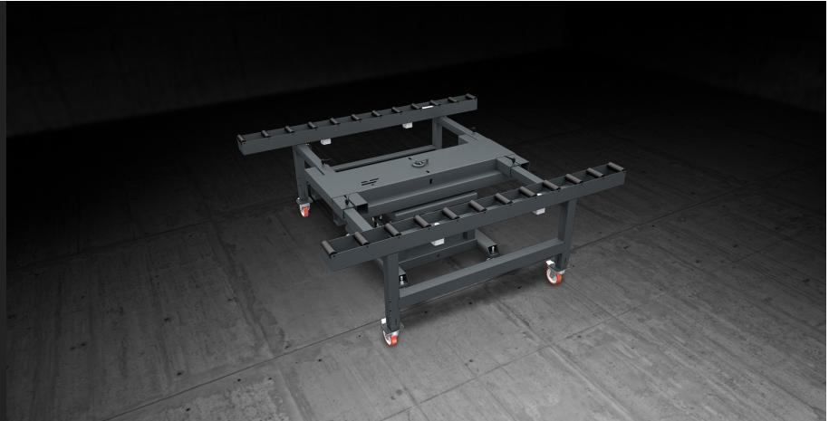
Bancada modular dedicada à ensamblagem e à movimentação em linha de células de fachada. Está implementada com 2 pistas de roletes revestidos com bainha de PVC macio; a distância entre as duas pistas é regulável de acordo com a amplitude da esquadria. Um sistema acionável pneumaticamente permite bloquear os roletes durante as fases de usinagem. A inteira bancada pode girar de 360° para facilitar as operações de ensamblagem e vedação da célula; a posição angular é bloqueada com comando pneumático.
