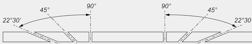
Механическая регулировка промежуточных углов наклона
