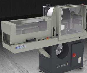
Машина для нанесения защитной пленки на алюминиевые профили. Профиль подается автоматически с помощью моторизованных роликов, а идеальное прилегание пленки к профилю обеспечивается с помощью прижимных роликов. Дополнительный по заказу комплект позволяет одновременно наносить пленку на третью грань профиля.
