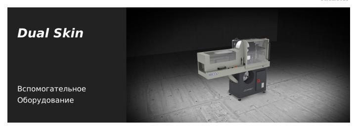
Машина для нанесения защитной пленки на алюминиевые профили. Профиль подается автоматически с помощью моторизованных роликов, а идеальное прилегание пленки к профилю обеспечивается с помощью прижимных роликов. Дополнительный по заказу комплект позволяет одновременно наносить пленку на третью грань профиля.
