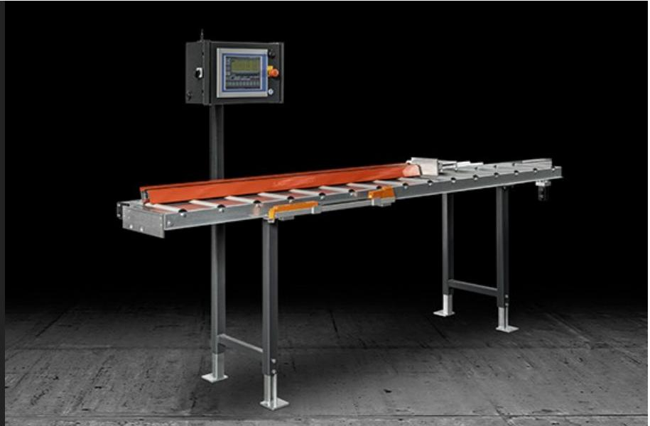
Система размерного упора и опора профиля с движением ограничителя на оси ЧПУ и электронным считыванием, используя абсолютную магнитную полосу. Она оснащена электронной системой измерения, позволяющей сохранять данные во внутренней памяти, либо передавать их в режиме реального времени на ПК или в блок управления пильного станка посредством Bluetooth. Это позволяет выполнять обработку с высокой точностью и повторяемостью позиционирования.
