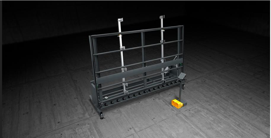
Испытательный стенд для алюминиевых переплетных конструкций. Он позволяет воссоздать условия эксплуатации переплетных конструкций: рама блокируется с помощью системы зажимов, регулируемых по всей высоте рамного переплета, внутрь рамы вставляются створки, стекла и производится окончательное испытание. Рольганг позволяет оператору загружать и разгружать тяжелые модули в режиме полной автономии.
