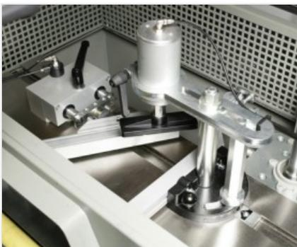
**Зажимной узел и положение вне прямоугольной опоры**
