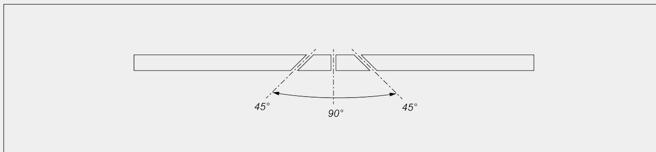
Механическая регулировка промежуточных углов наклона
