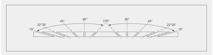
Электронная регулировка промежуточных углов наклона
