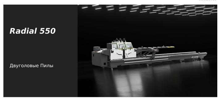
Электронный двухголовочный пильный станок с радиальным движением режущих дисков, автоматическим перемещением подвижной головки на шарикоподшипниковых ползунах с шестеренно-реечной передачей; внутренний наклон до 30°, разработана для резки профилей крупных размеров. Подача режущего диска приводится в действие парой гидравлических цилиндров.
