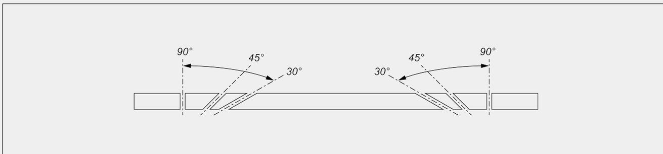
Электронная регулировка промежуточных углов наклона
