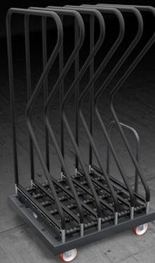
Картка для транспортировки и складирования створок. Опорная станина каждого отделения оборудована роликами, упрощающими перемещение тяжелых или больших заготовок.
