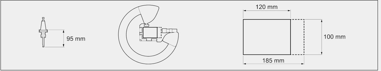
4 yüz üzerinde işlenebilir azami kesit - L x H (mm)
