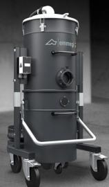
Tek emiş ağızlı, alüminyum ve PVC talaş emiş sistemi; makinenin ve çalışma ortamının temizliğine ya da yüksek vakum değerlerine ihtiyaç duyan talaşların çalışma ünitesinden emilmesine yöneliktir. Yüksek vakumlu yan kanallı turbinin kullanılması, farklı emiş ihtiyaçlarına uygun hale getirmektedir. Antistatik filtre, titreşimli filtre otomatik temizleme sistemi, emilen malzemenin basit ve hızlı tahliyesi için tekerlekli hızlı ayırmalı toplama deposu ile donatılmıştır.
