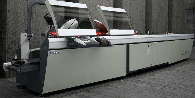
Otomatik hareketli kafa ile donatılmış, kontrollü 3 eksenli, 45°'ten (iç) 15°'e (dış) kadar bütün açıların, her bir derece içinde 280 hassasiyet konumu ile elektronik olarak kontrol edildiği, çift kafalı kesim makinesi. Bıçağın ilerleyişi bir çift oleo-pnömatik silindir ile sağlanmaktadır.
