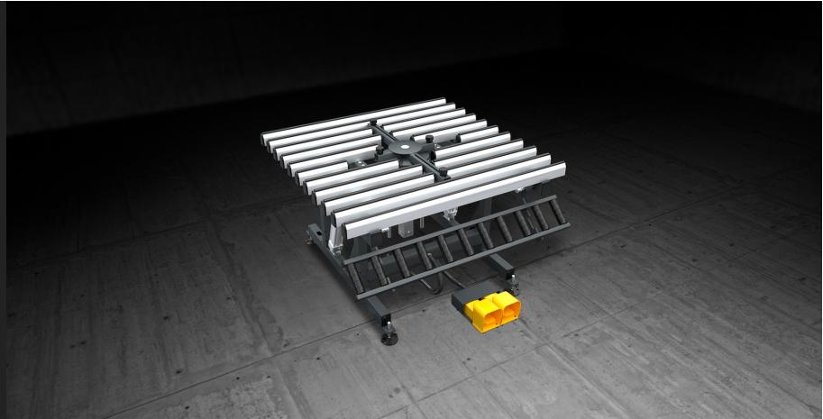
用于组装玻璃窗板的工作台，加工台面可从 0°（水平）到 85° 范围内倾斜。伸缩式辊筒输送机可以独立于加工台，高度可调（从 170 到 460 毫米）。工作台可在 895 至 965 毫米之间调整，支脚设有地面固定孔。工作台配备了一个中央十字杆，用于抬升并定位玻璃。
